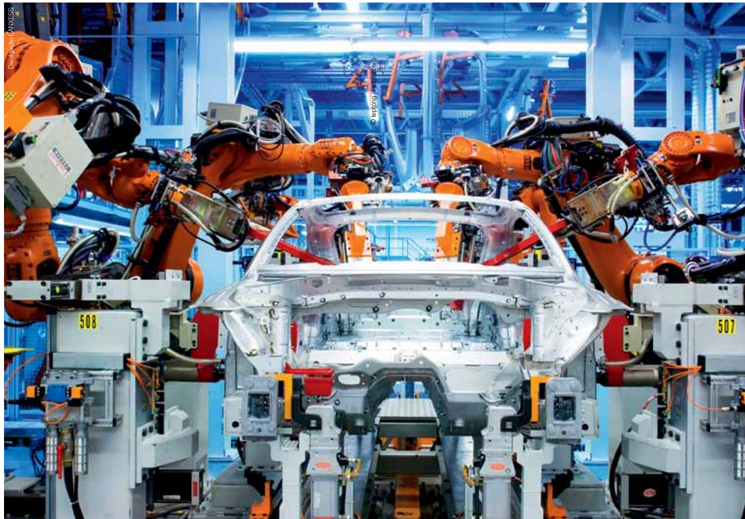
Linha de montagem do Audi TT: a estrutura da frente do automóvel é um exemplo da tecnologia híbrida que combina plástico (náilon) e metal (alumínio)
